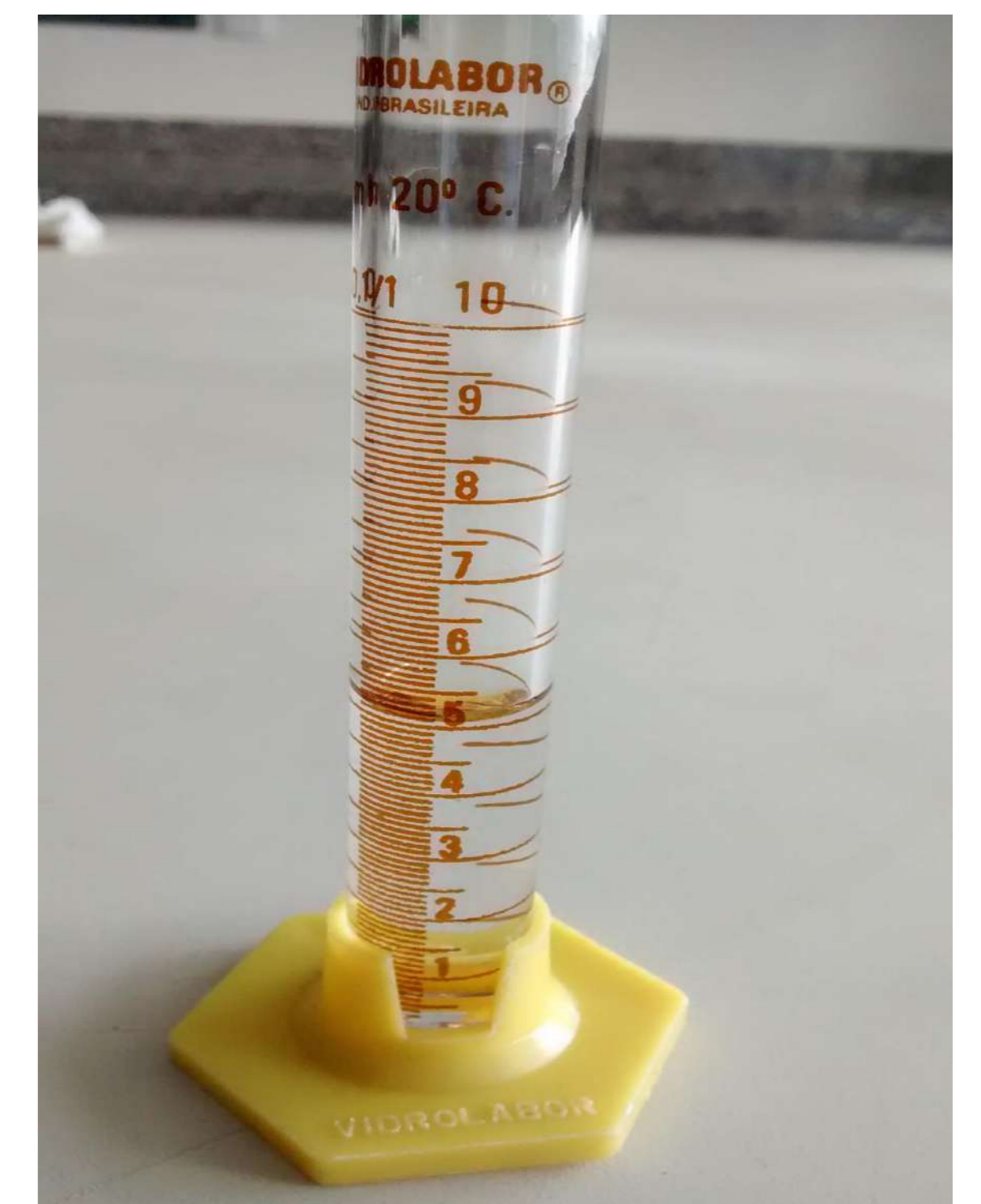
Figura 2: Quantidade de álcool produzido a partir de 100g de mandioca cozida + 10g de fermento biológico + 400 ml de água
